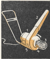
Зерномет конструкции Григоровича. 1 — электромотор, 2 — дуло, 3 — шнек, 4 — защитная решетка, 5 — турбина
